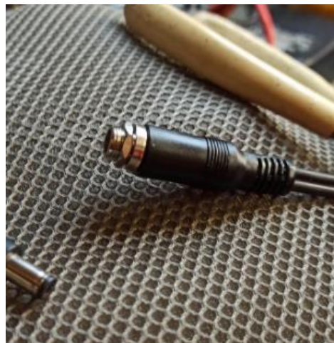
nieuw chassisdeel in oude behuizing met dik snoer
