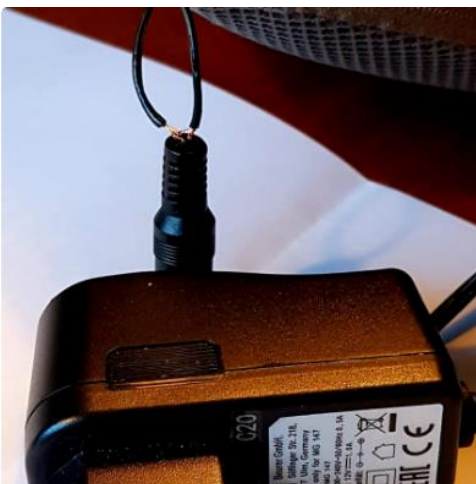
met gebroken gebroken draad
